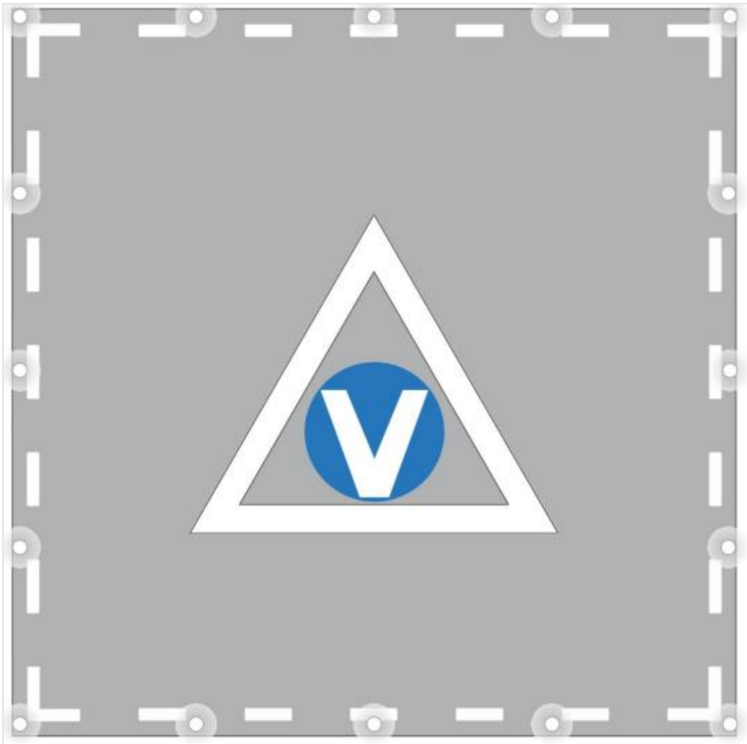
Слика Е-25. Светла зоне завршног прилаза и полетања ( FATO ) на вертидрому у нивоу са земљом
