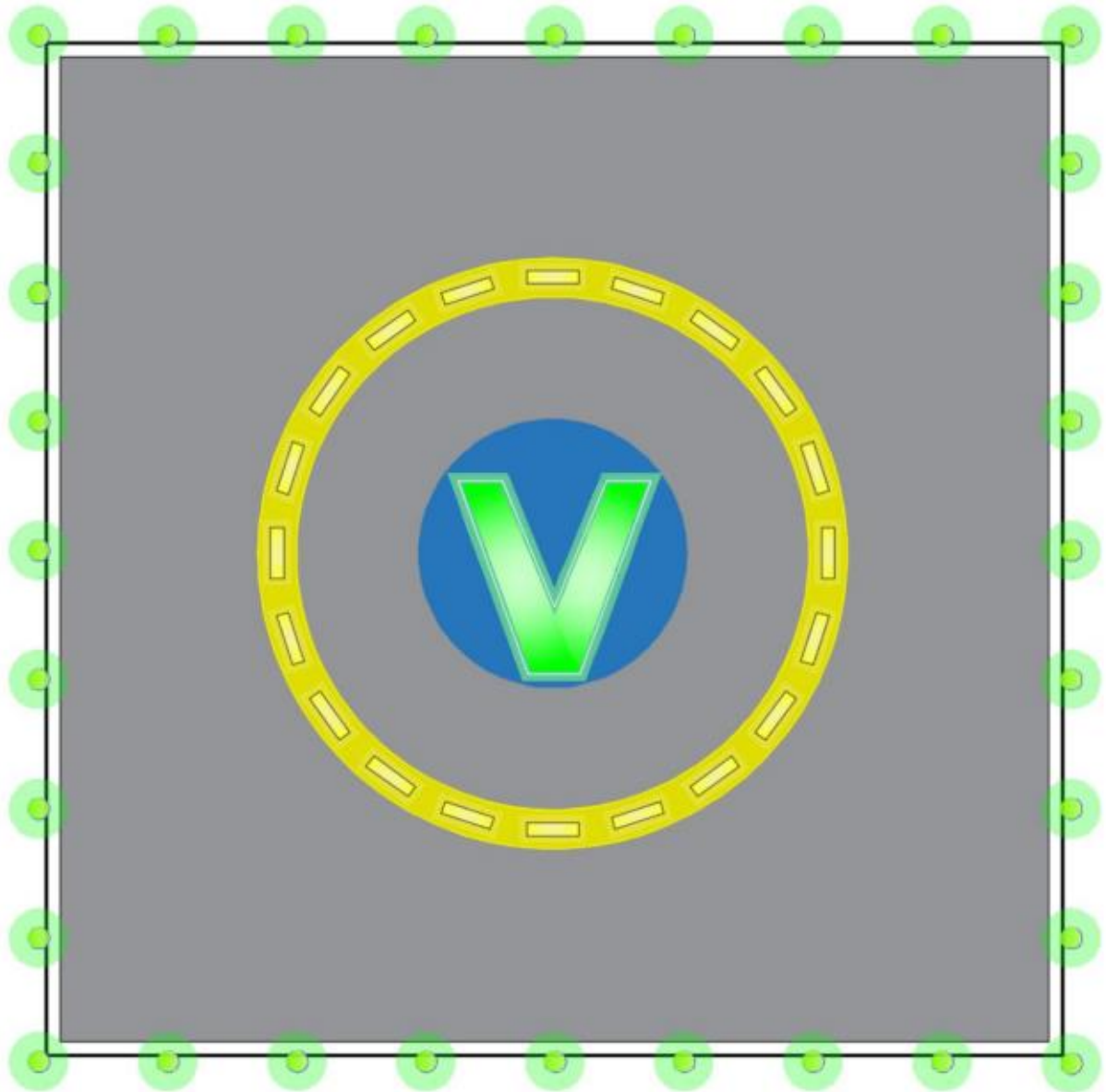
Слика Е-35. Гранична светла издигнутог вертидрома, светла идентификације вертидрома и светла круга тачке додира/позиционарања (TDPC)
