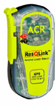
за личну употребу (углавном на копну, али под одређеним условима и у поморству и ваздухопловству) - Personal Locator Beacon (PLB)
