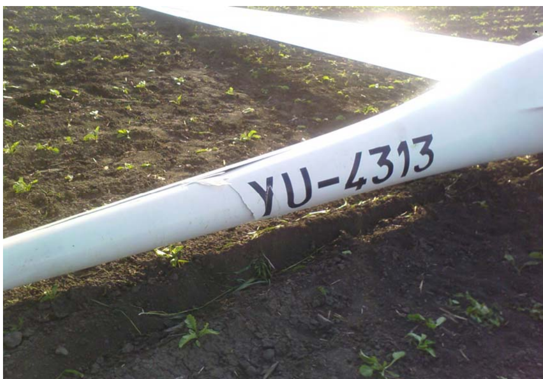
Сл.2. Оштећење трупа јед рилице (снимљено након извлачења једрилице из пшенице)
