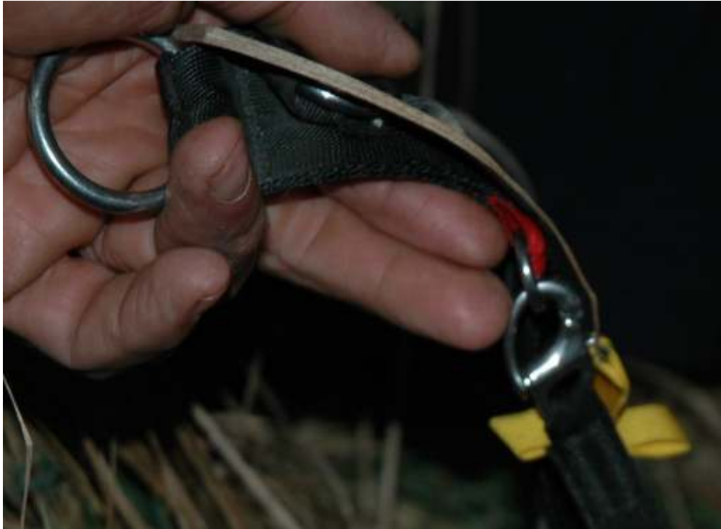
Фот. 5: Одбацива копча RSL-а закачена за десни слободни крај главне куполе (DSC 0494, CD 1)
