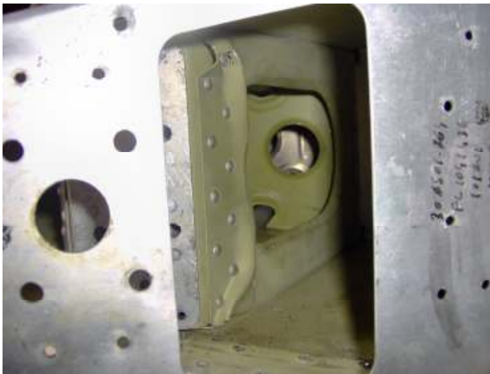
Слика 2. Детаљ оштећења структуре у зони првог ребра левог крила
