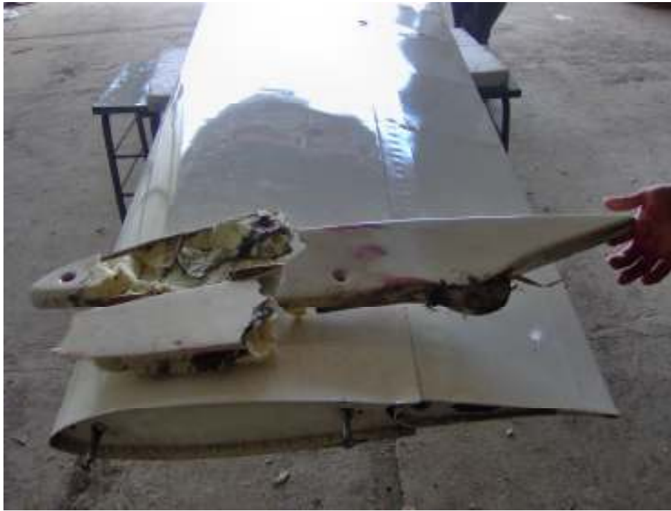
Слика 1. Оштећењс терминезона левог крила
