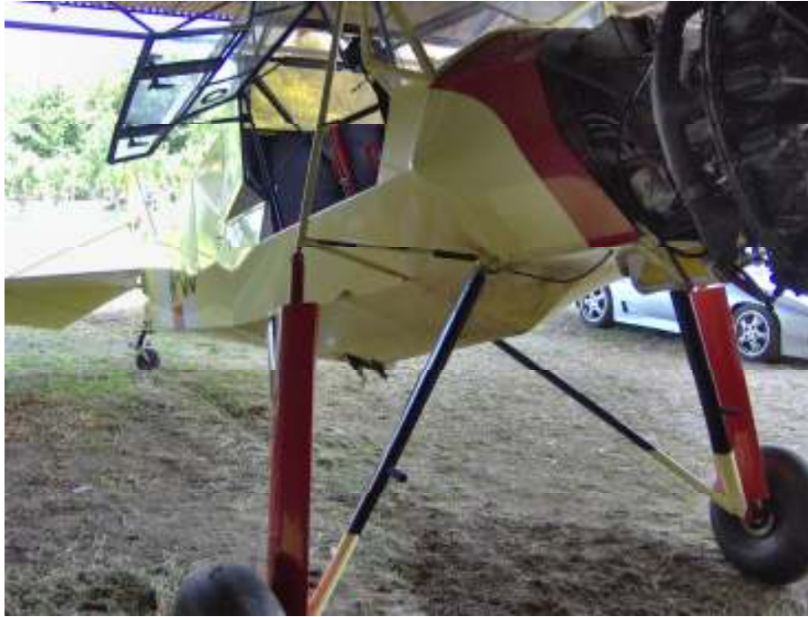
Упорнице стајног трапа након заваривања, после удеса
